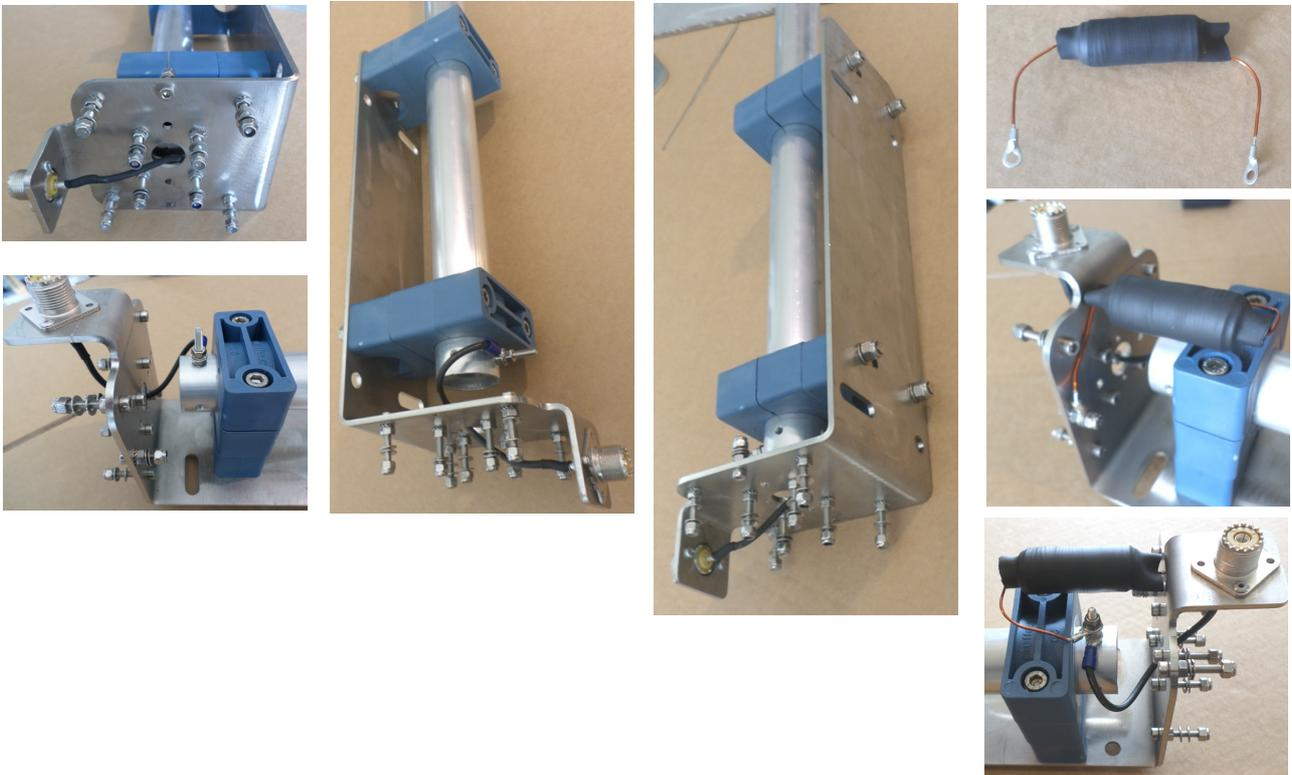
La cura e la precisione di questo assemblaggio assicurerà una lunga vita all'antenna. Controllare che tutti i bulloni siano stati correttamente fissati e completate il serraggio dei bulloni. Con l'ausilio dei collari ad U, installate la base sul palo di supporto ed installate i radiali. I collari ad U sono da 50mm, ma possono arrivare a stringere pali o tubi fino a 40mm.
